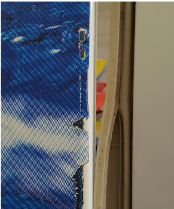
Puerta de heladera donde se observa que no cierra por completo, el burlete está despegado pudiéndose observar el contenido de la misma a través de la abertura.
