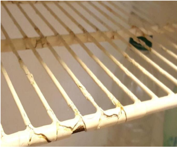
Heladera con pintura de levantada y oxidada
