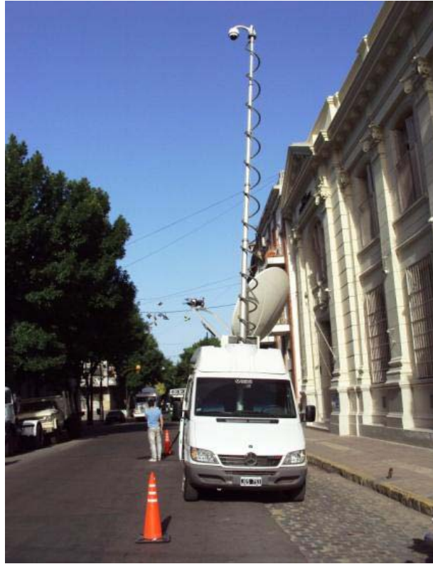
Camión de exteriores con cámara periscopio y antena parabólica para transmitir imágenes
