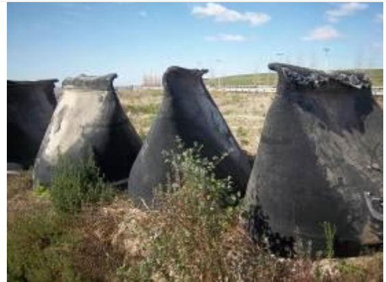
Foto 27 - Válvulas tipo "pico de pato" desechadas
