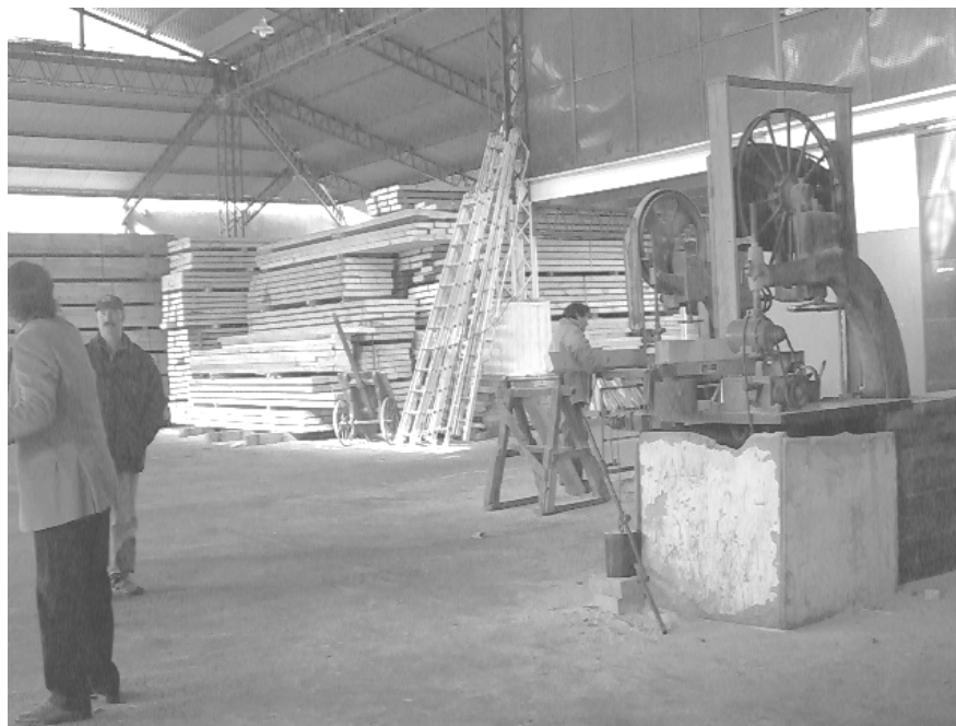
Foto N° 4 – Vista del interior del galpón-depósito donde se observan las maderas del depósito, escaleras y maquinarias (sierras, caballetes, etc.). Este lugar sirve de depósito y taller de carpintería donde se procesan las maderas para el trabajo diario. Es de notar que el personal no usa antiparras como elemento de seguridad para operar las sierras y tampoco cascos protectores.
