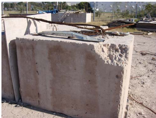
Foto: Bloque de hormigón pobre confeccionado in situ
