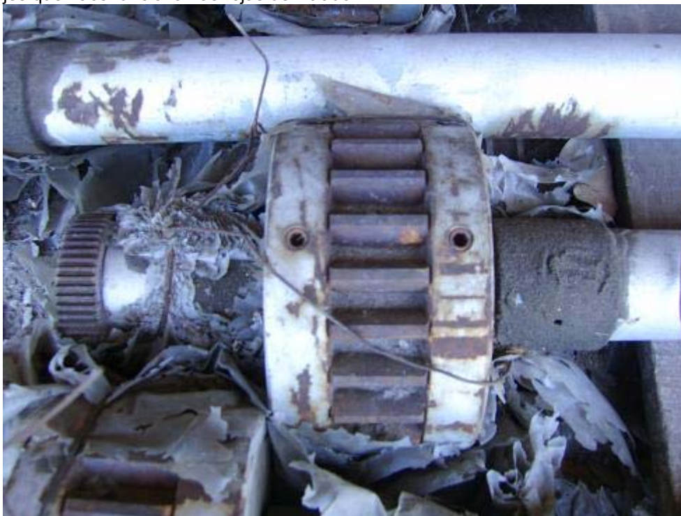
Foto 22, 23, 24, 25. Diferentes tomas del estado de los elementos que corresponden al sistema de engranajes que hace funcionar las rejas de filtrado.
