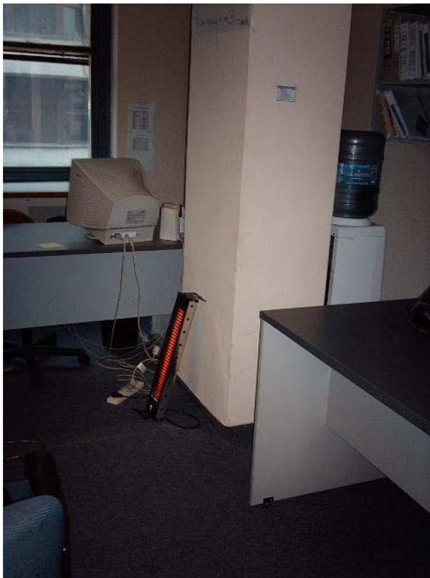
Artefactos eléctricos de calefacción riesgosos. Claro indicador que el sistema central de acondicionamiento de aire no funciona.
