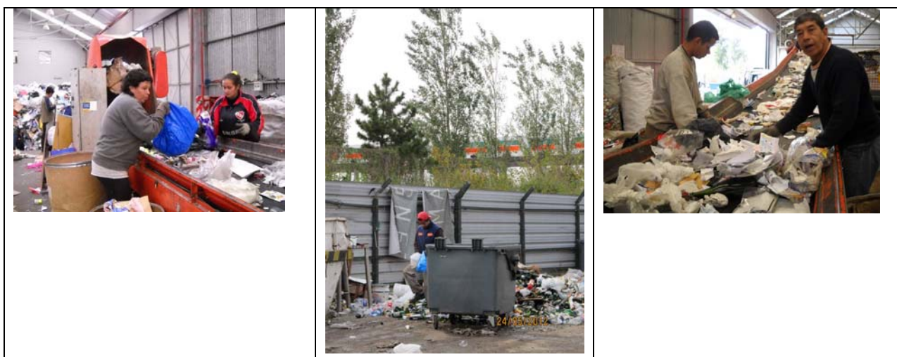
Foto N° 27, 28 y 29: Falta de Elementos de Protección Personal para la manipulación, apisonamiento de vidrios y clasificación del materiales (botines de seguridad, botas de goma para tareas en húmedo, protectores visuales y auditivos adecuados, guantes de nitrilo para tareas en sector de clasificación de materiales, protección respiratoria para tareas en sector clasificación (barbijos), faja dorso-lumbar para tareas de levantamiento de carga.).
