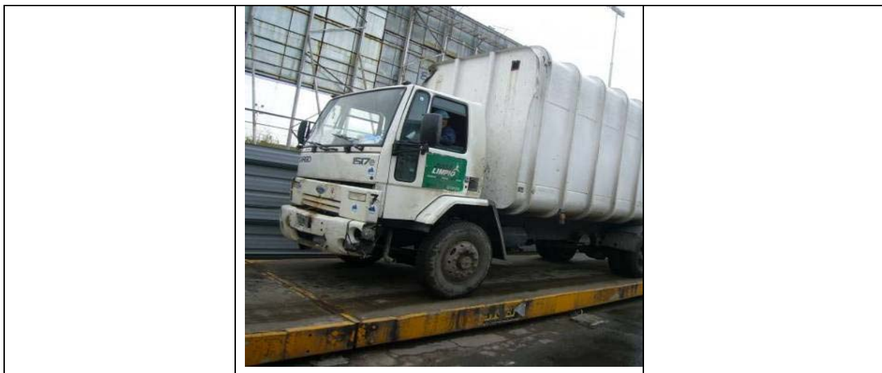
Foto N° 1: Balanza para pesaje de vehículos en funcionamiento.
