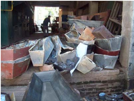
Foto 28: Cajas metálicas retiradas del horno. Obstruye vía de escape al exterior.
