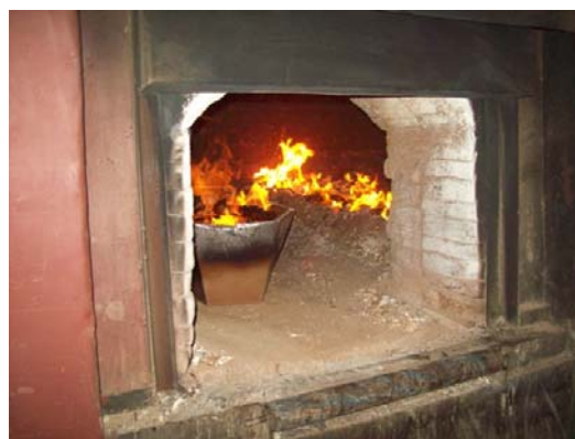
Foto 15: Cremación en Caja Metálica.
