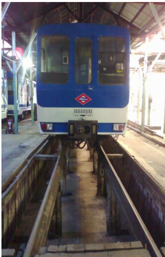
Fosa de trabajo. Incorporación sistema ATP. (Alstom)
