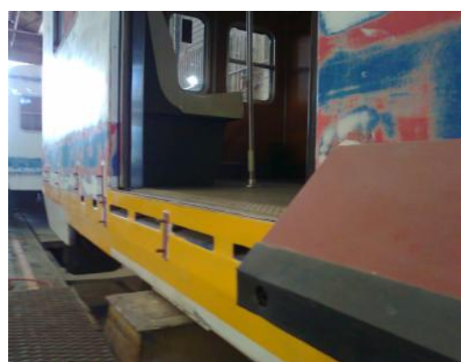
Detalle de adaptación de solapas coche – andén.
