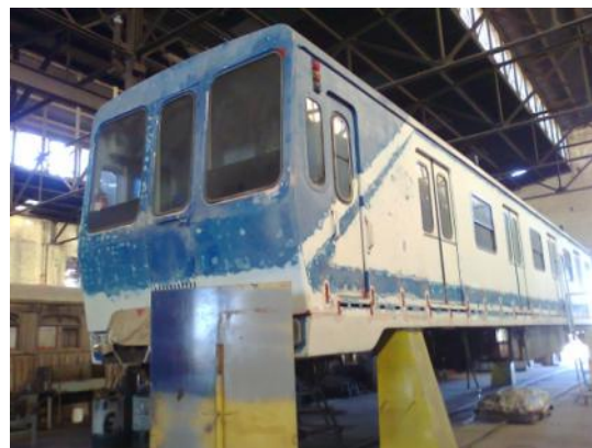
Lijado y tratamiento anticorrosivo.
