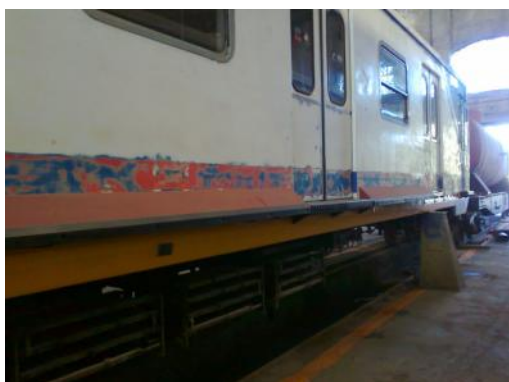
Montaje de los coches sobre caballetes para proceso de Remodelación de los mismos.
