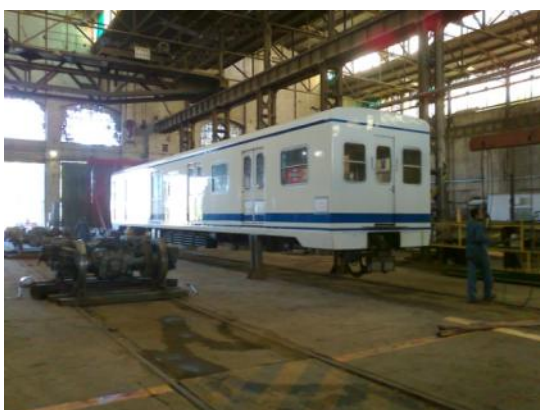
Desmontaje de bogies.
