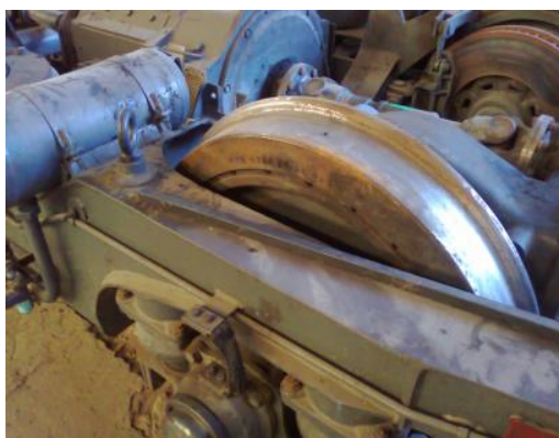
Bogie. Detalle sistema de tracción.
