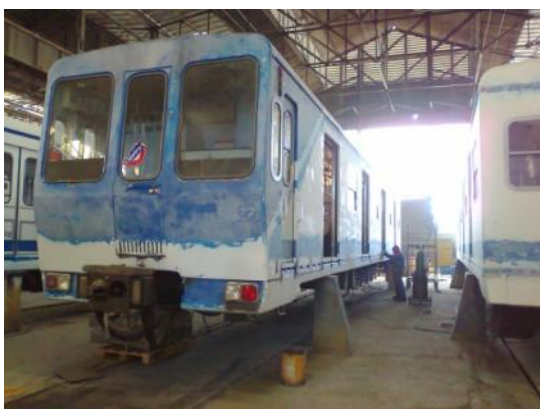
Adaptación solapas coche – andén. (Preparación).
