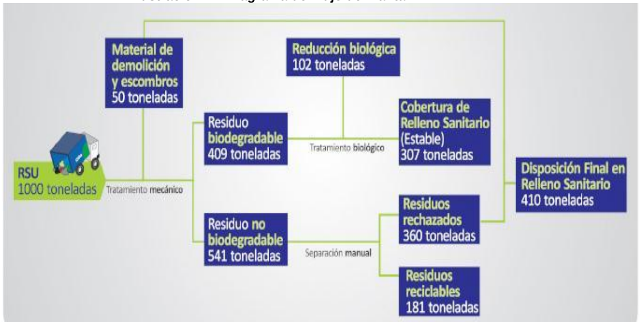
Ilustración 4 – Diagrama de Flujo de Planta MBT
