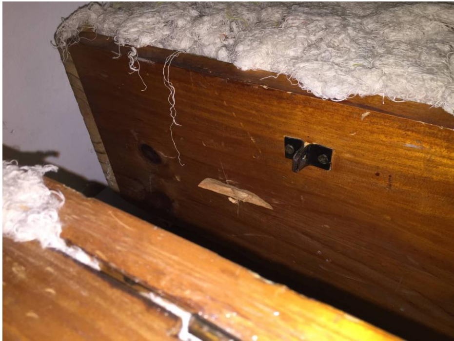
Cajón de prueba balística perforado en el lateral por un disparo
