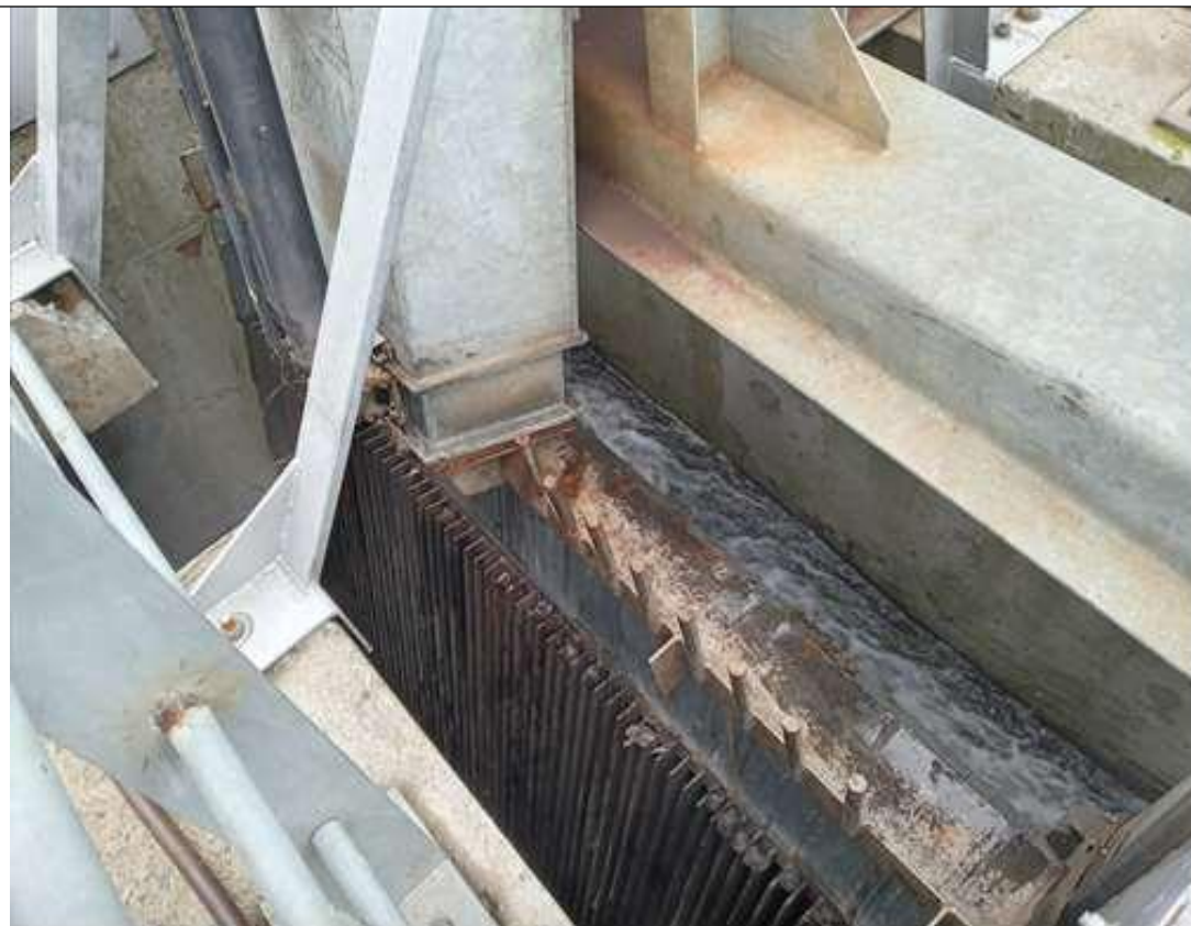
Sistemas de Hidrojet: Expulsa agua a presión sobre la canaleta para empujar los residuos hacia el canasto de recolección.
