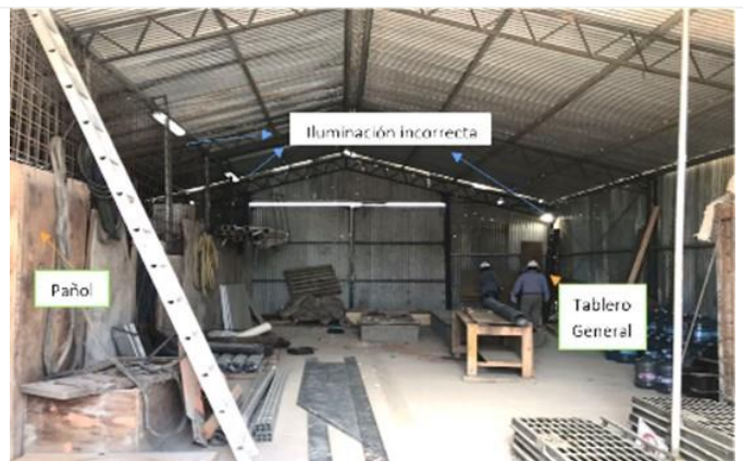
FOTO Nº 8 - Ingreso al taller y pañol: falta de orden y limpieza, señalética. Tablero general en un extremo del galpón iluminación mal distribuida, sin luz de emergencia.
